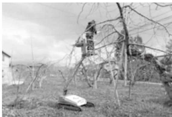
▲はしごに替え高所作業車での剪定作業
