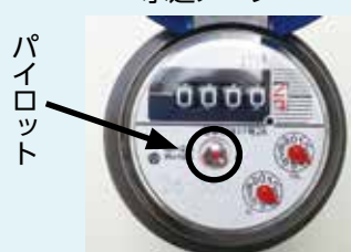
水道メーター
