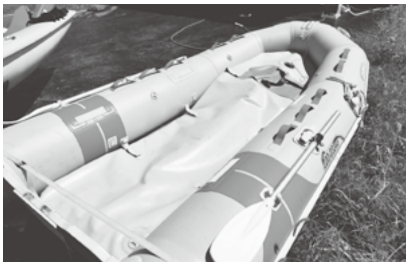
▲本来、床は平らでないといけないが、このように空気漏れで使用できない
